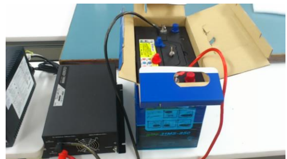
図5. 正弦波インバーターとバッテリーを用いた電源システム
